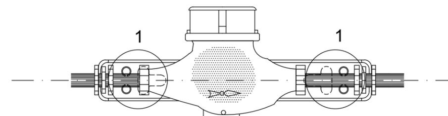
1 ZONA PARA APLICAÇÃO DE PARAFUSOS DE FIXAÇÃO
